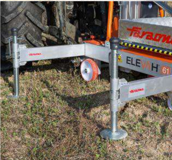
A 4 támasz lehetővé teszi a készülék megfelelő szintezését.
