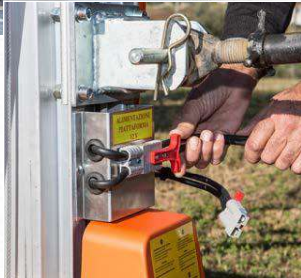
Áramellátás: 2X12V extra AKKUMULÁTOR vagy 12 Volt traktorról.
